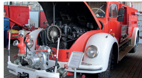
Schaumtankfahrzeug mit geöffneter Motorhaube und Vorbaupumpe, Foto: FMSH
