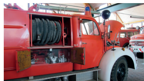
Blick auf die Schnellangriffseinrichtung des Schaumtankfahrzeugs, Foto: FMSH
