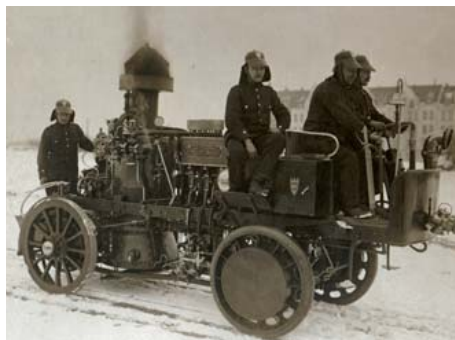
Dampfspritze der Feuerwehr Kiel mit nachgerüstetem Dampftrieb, Foto: Archiv Gihl
