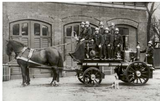
Eine der sechs kleinen bespannten Hamburger Dampfspritzen von Shand, Mason & Co, Foto: Archiv Feuerwehr Hamburg
