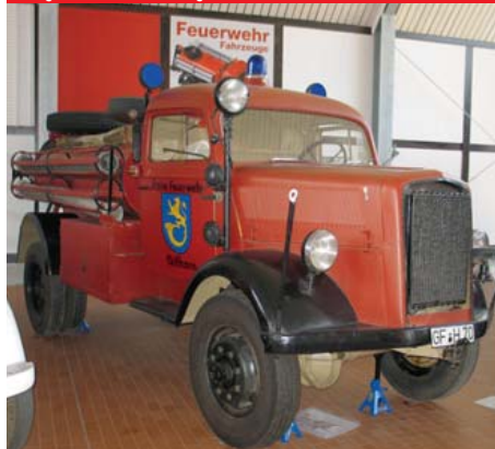
Tanklöschfahrzeug TLF 1 aus dem Jahr 1944 in der Spender-Halle, Fahrgestell Opel und Aufbau Magirus (Inv.-Nr. 2014), Foto: FMSH
