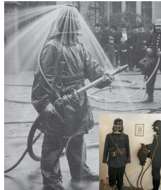
Demonstration des Rauchhelms der Firma König („Feuerttaucher“) auf dem Hof der Zentralfirewache Altona in der Mörkenstraße im Jahr 1890, Fotos: FMSh
