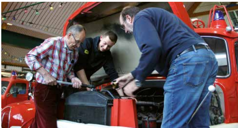
Wolfgang Grasemann, Jan Sieber und Werner Schwartinsky öffnen den Wasserkühler eines Schaumtankfahrzeugs, Foto: Mathias Schwartinsky
