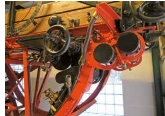
Kohlensäuremotor zum Ausfahren der Drehleiter, Foto: FMSH
