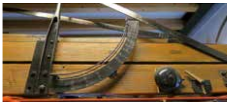
Anzeige für den Neigungswinkel der Drehleiter, Foto: FMSH
